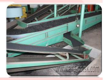
Сепарирование сырья на магнитном сепараторе
