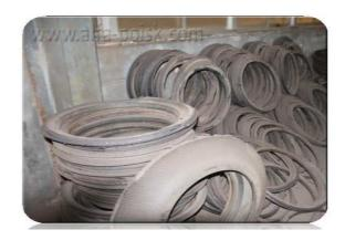
**II. Шаг:** шину с удаленными бортами помещаем в машину для нарезания на ленты и получаем резиновые ленты.
